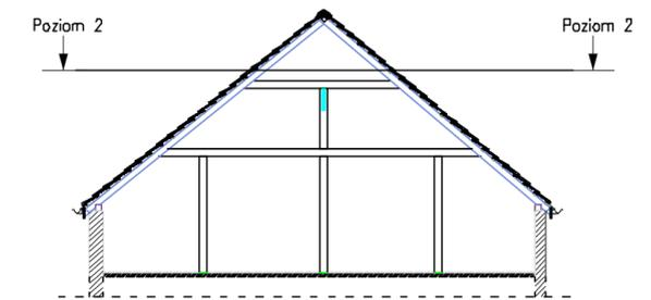
Przekrój orientacyjny pokazujący aktualną płaszczyznę cięcia oraz poziom inwentaryzowanej części budynku.
